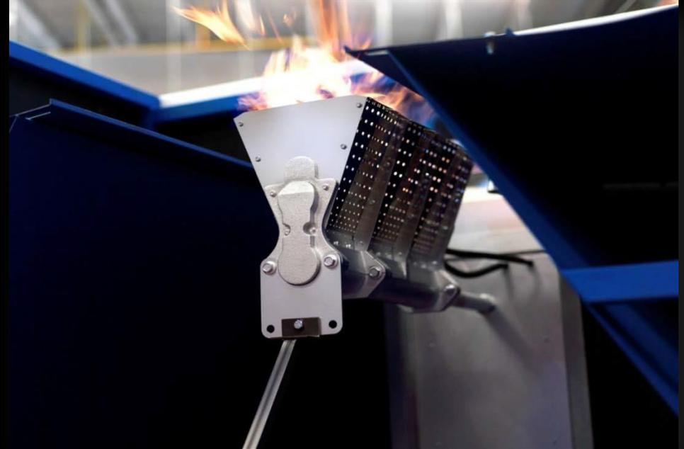
THE VERY HIGH RISING AND LOWERING OF TEMPERATURE IS MADE BY **DIRECT COMBUSTION BUTANE OR NATURAL GAS BURNERS** WITH GREAT ADVANTAGES IN FRONT OF STANDARD COMBUSTION OR ELECTRIC HEATING. ADVANTAGES LIKE **QUICKNESS, LOWER CONSUME BY AT LEAST 1/3, LOW MAINTENANCE, GREAT EFFICIENCY, AND ENVIRONMENT FRIENDLYNESS.**
